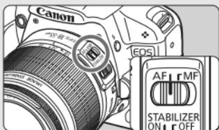
**Coloque o interruptor de modo da focagem da objectiva na posição <AF>.** (p. 33)
